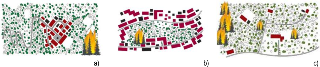
Figura 10. Tipologie di incendi di interfaccia: classica (a), occlusa (b) e mista (c)
